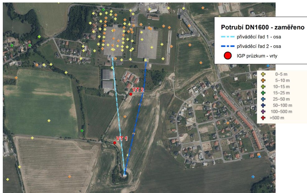
Obr. 1 Inženýrsko – geologický průzkum, umístění vrtů (křížky značí archivní vrtů z Geofondu)
