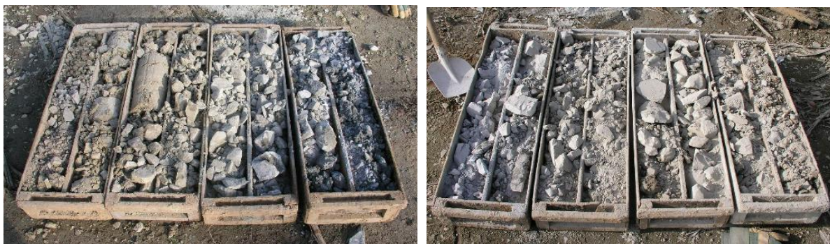
Obr. 2 Jádru průzkumných vrtů – VJ1, VJ2
